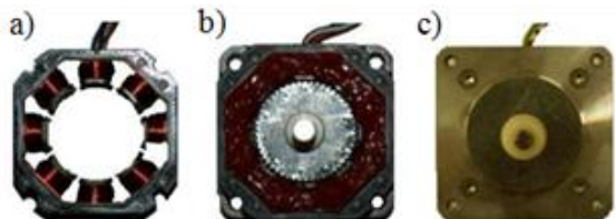
Rys. 6. Budowa hamulca MR: a) widok cewek, b) wnętrze hamulca, c) widok zewnętrzny
