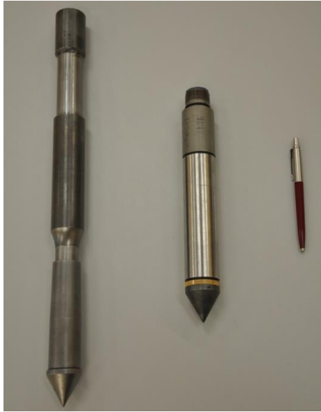
Foto. 3.1. Stożek mechaniczny Begemanna (CPT) i stożek piezoelektryczny (CPTu) [W.Szajna]
