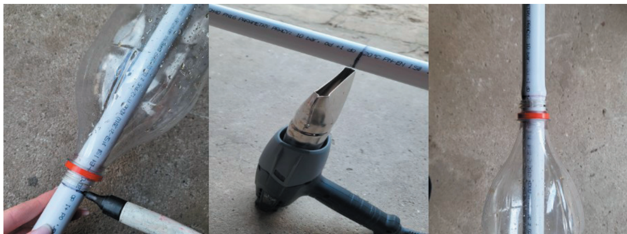
Rys. 5. Montaż mechanizmu zwalniającego platformy startowej
