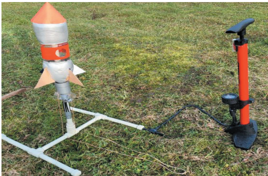
Rys. 12. Rakieta na wyrzutni podczas pompowania powietrza do jej wnętrza
