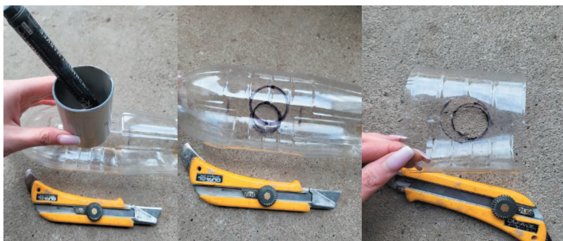
Rys. 7. Przygotowanie elementu sprężynującego mechanizmu zwalniającego platformy startowej
