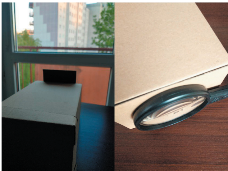
Rys. 7. Wykonywanie zdjęcia aparatem otworkowym z wykorzystaniem lupy jako obiektywu Źródło: opracowanie własne.
