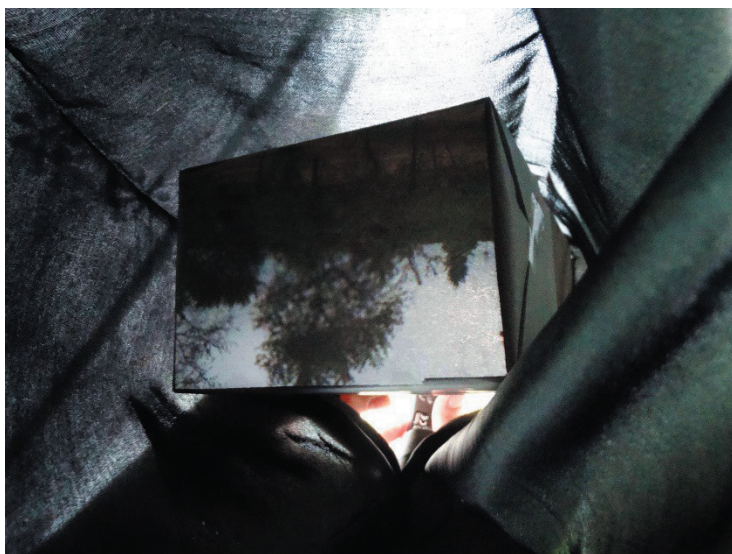
Rys. 6. Obraz widoczny na matówce wykonanego aparatu otworkowego Źródło: opracowanie własne.
