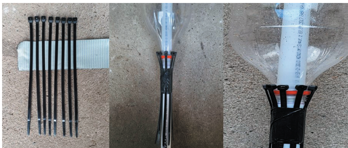
Rys. 6. Montaż mechanizmu zwalniającego platformy startowej
